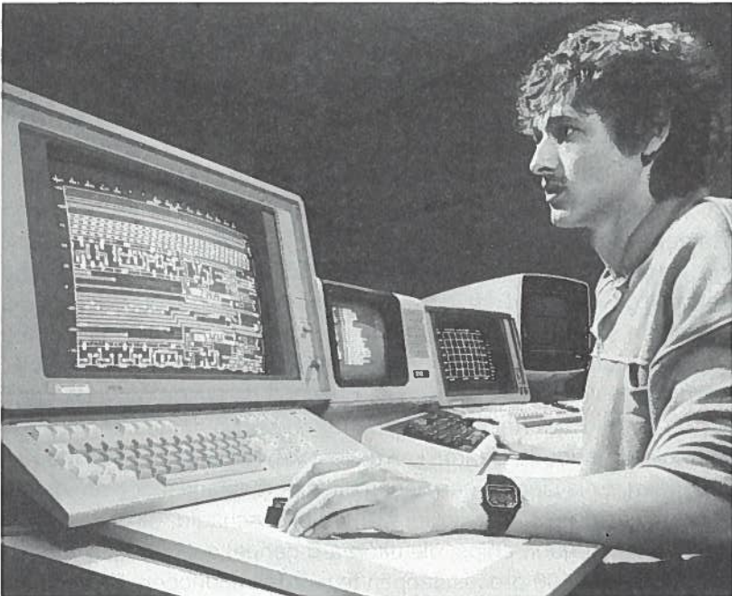
afb. 2. In het ontwerpcentrum worden met behulp van computer-terminals de ontwerpfasen van een IC gerealiseerd.
